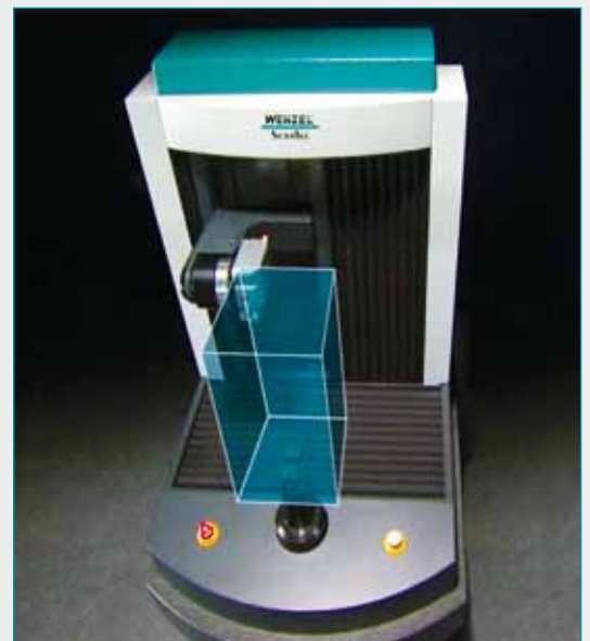
Verfahrbereich von 300 x 200 x 450 mm
