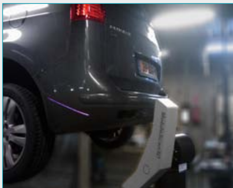
Der MobileScan3D Sensor hat kein Problem bei der Zugänglichkeit, um die Features unter dem Fahrzeug zu erfassen
