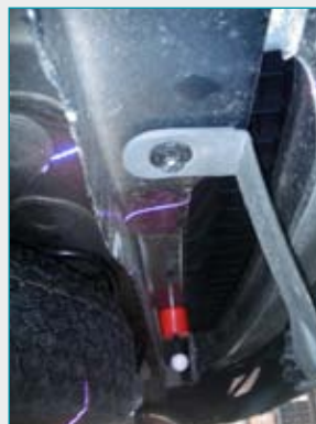
Der MobileScan3D Sensor hat kein Problem bei der Zugänglichkeit, um die Features unter dem Fahrzeug zu erfassen
