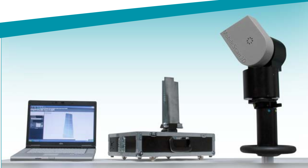
Typischer Aufbau des 100 mm Sensors
